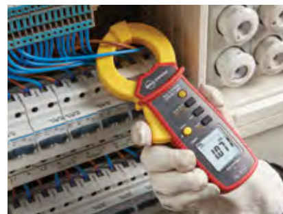
Měření rozdílového proudu s měřením unikajícího proudu kleštvými ampérmetry
