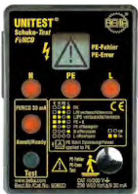
Test proudového chrániče RCD/Schuko FI
